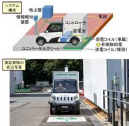
図2.4.17 無線給電の概念図と実施状況 資料：大林組 プレスリリース
