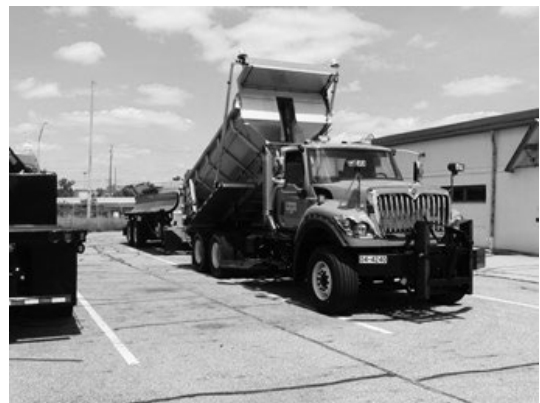
写真-4 牽引除雪車
